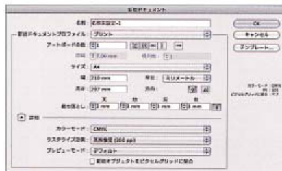
02-1 プリント用プロファイルでは、[サイズ]は一般用紙の規格。[単位]はミリメートル。[カラーモード]は[CMYK]、[ラスタライズ効果]の解像度は[高解像度(300 ppi)]に設定されるほか、[裁ち落とし]でアートボードに印刷用のマージンが天地左右3ミリ設定される
